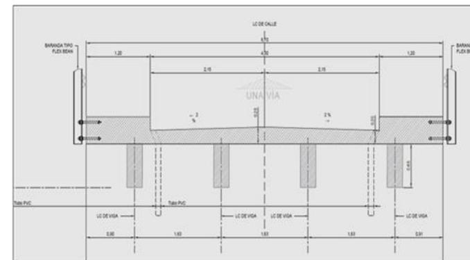
Sección transversal y longitudinal del puente
